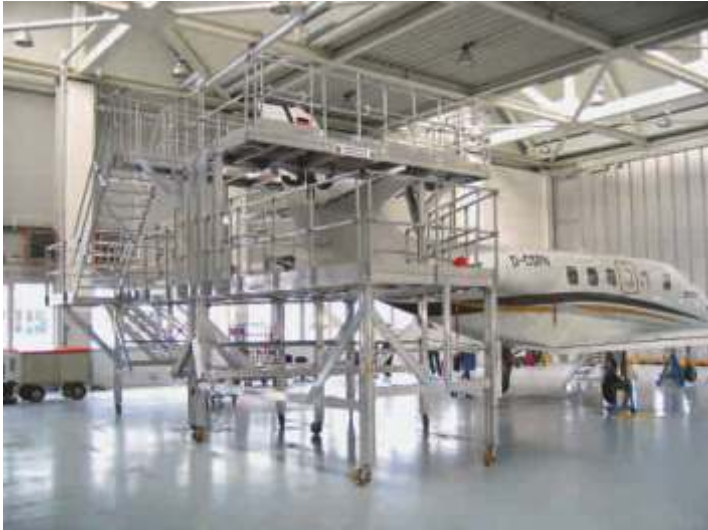
- Puente para alas de avión y plataforma móvil para propulsor.
