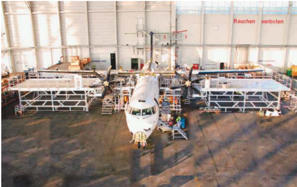
- Puente para alas de avión y plataforma móvil para propulsor.
