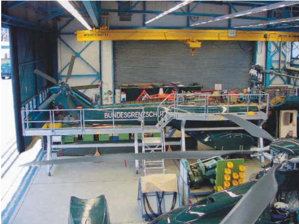
- Sistema de pasarelas móviles con alturas de trabajo variable. Escapera con peldaños anchos, barandillas y pasamanos laterales.
