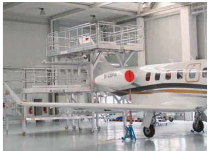
- Puente móvil de 2 niveles de trabajo.
