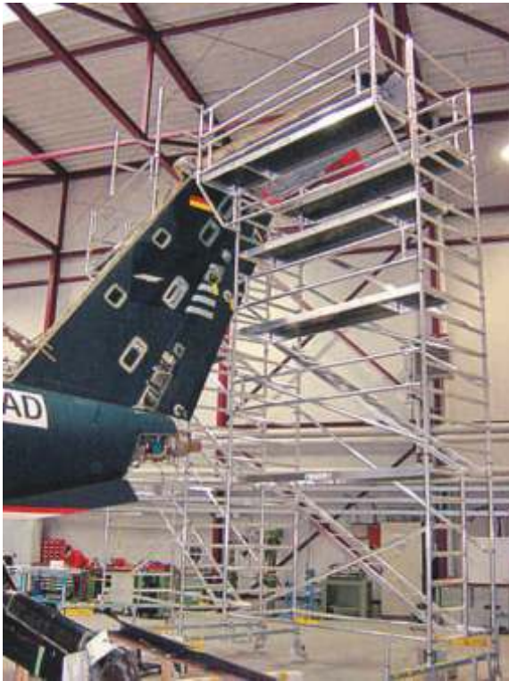
- Andamio con saliente ideal para la cola de los aviones.
