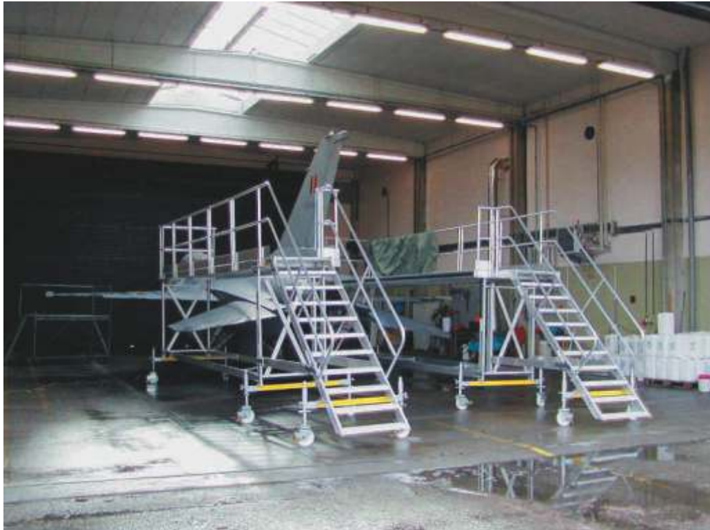
- Escalera con plataforma de trabajo y subida frontal confortable, base con ruedas regulables, barandilla en un lado y pasamanos de ambos lados de la escaleras.
