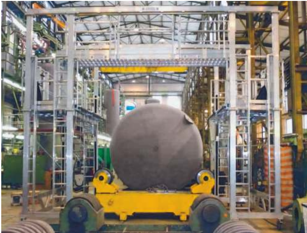
- Plataforma de trabajo móvil regulable en altura con puente dotado de barandillas y escalera de acceso.
