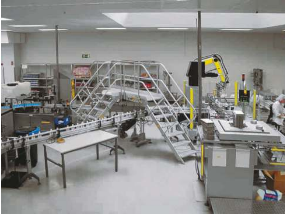
- Puente con 3 rampas de subida, barandilla de protección y pasamanos.
