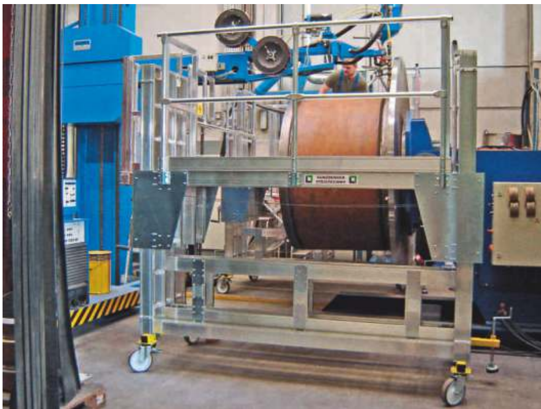
- Plataforma de trabajo móvil de altura ajustable.
