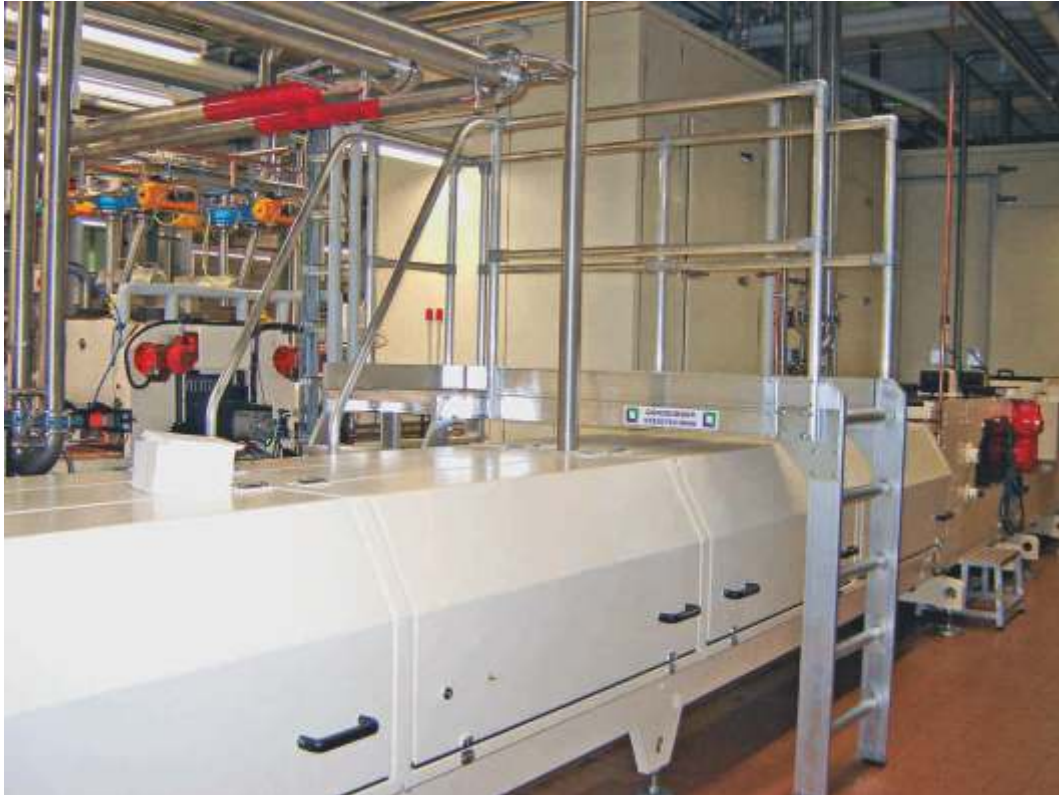
- Escalera de puente de doble subida vertical y con rampa.
