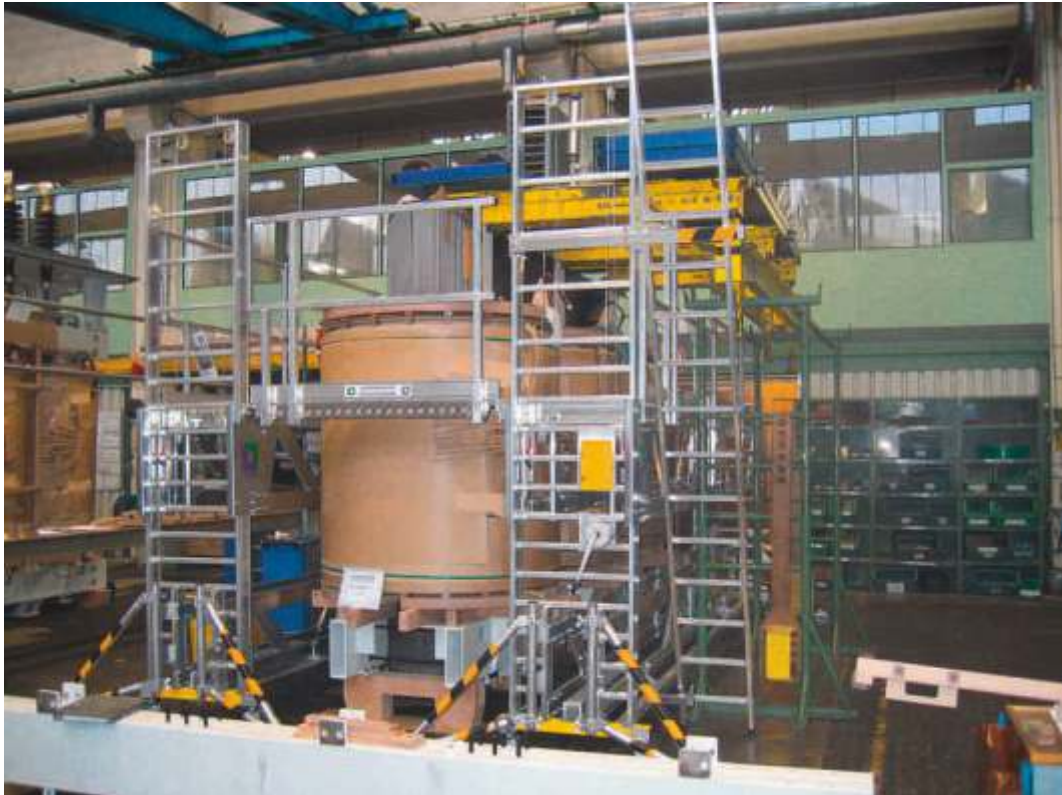
- Puente de trabajo móvil de altura ajustable con plataforma intermedia que se puede poner en diferentes niveles.
