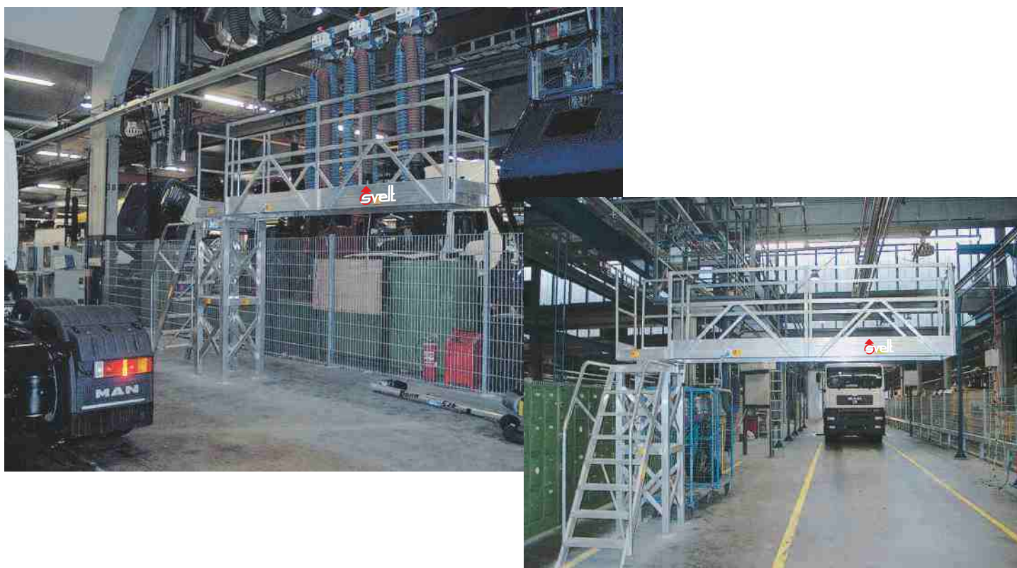
- Plataforma de trabajo que se puede girar con escalera de acceso fija.
