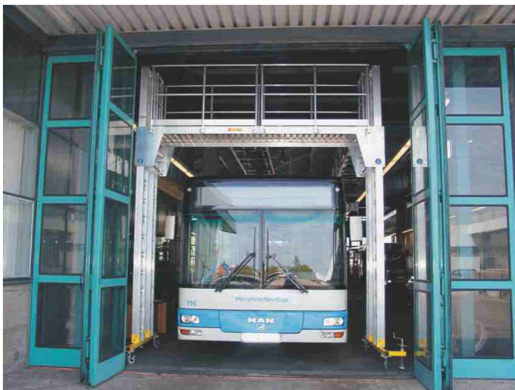
- Plataforma de trabajo móvil, sin refuerzo y con altura ajustable.
