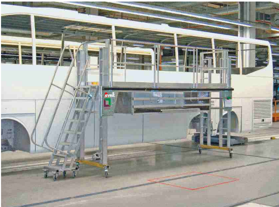
- Plataforma de trabajo sin refuerzos para trabajos de mantenimiento, altura ajustable y escalera de acceso.
