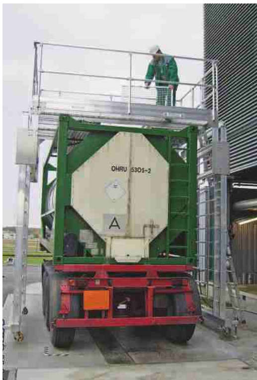
- Puente de trabajo móvil, sin refuerzos y plataforma con trampilla sobre el vehículo.
