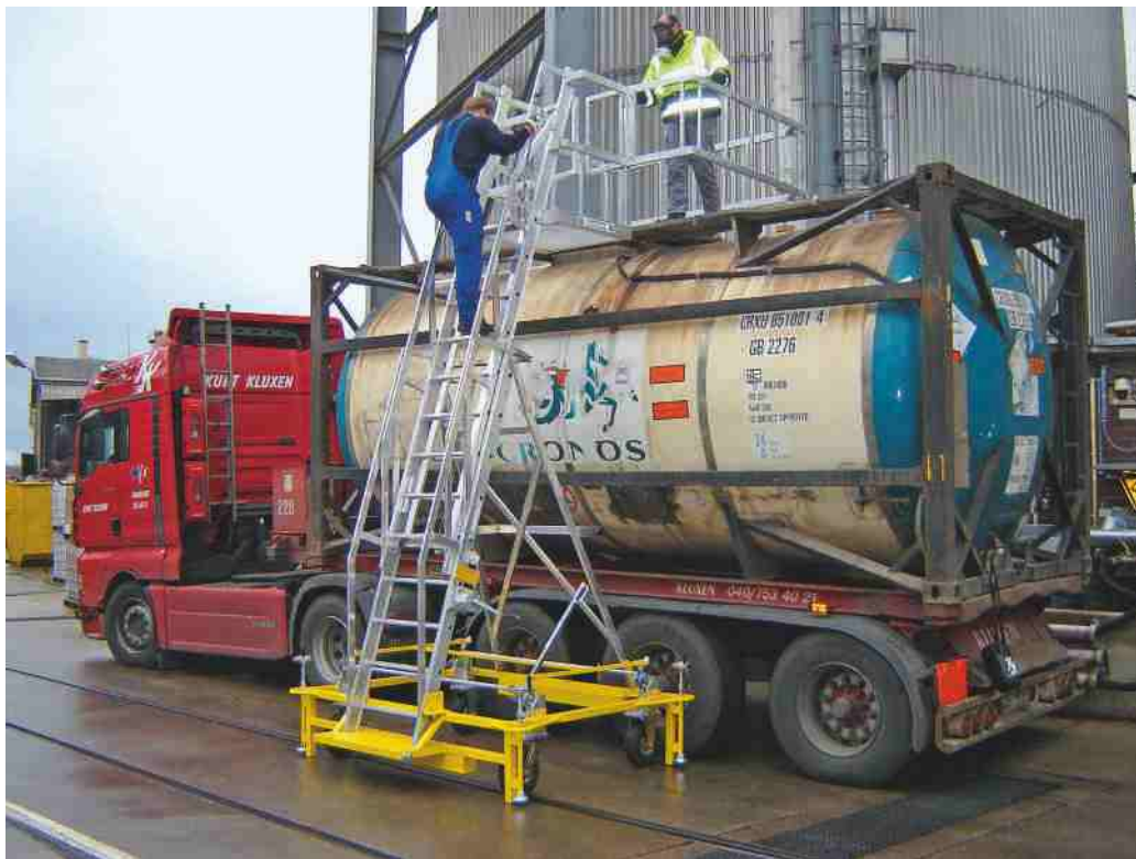
- Escalera para camiones cisternas: Altura regulable a través de una manivela - 2 ruedas giratorias con freno + 2 de dirección - Corrimano/ Jaula de protección – Plataforma de estacionamiento y salida - pasamanos.
