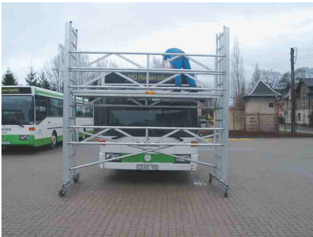
- Plataforma de trabajo móvil con refuerzo y altura ajustable.
