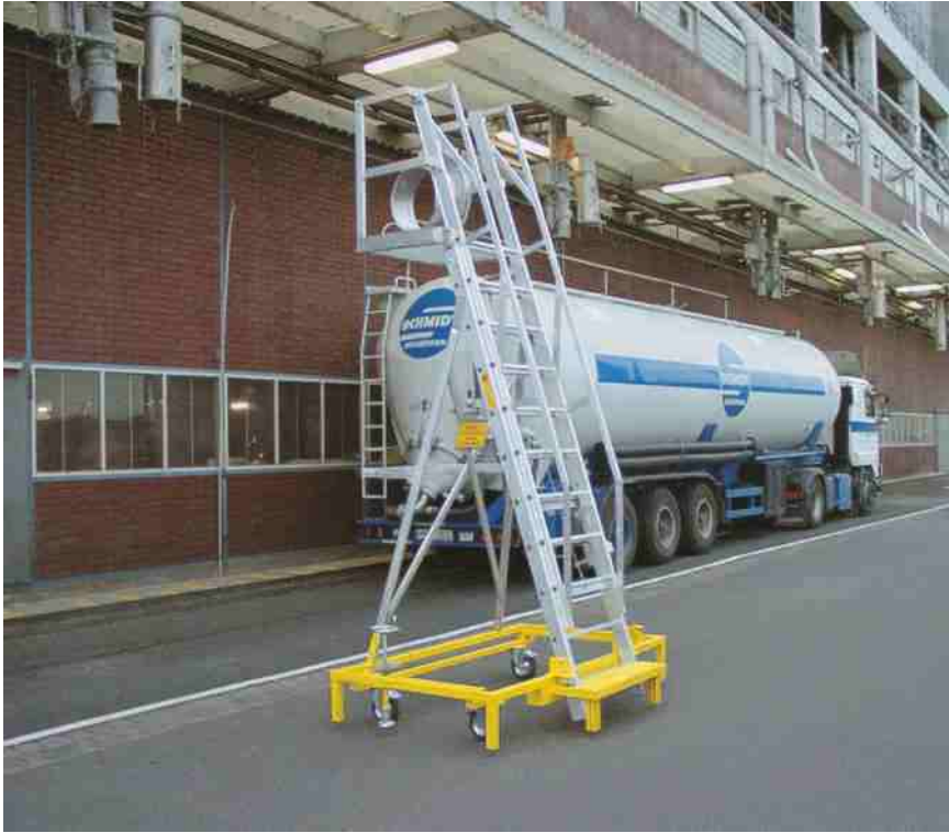
- Escalera para camiones cisternas, con altura regulable y jaula de protección.
