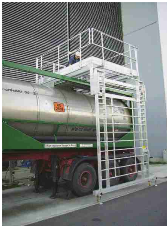
- Puente de trabajo móvil, sin refuerzos y plataforma con trampilla sobre el vehículo.
